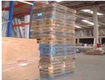
Las paletas de madera vacías no deben almacenarse en alturas superiores a 3,8 m
