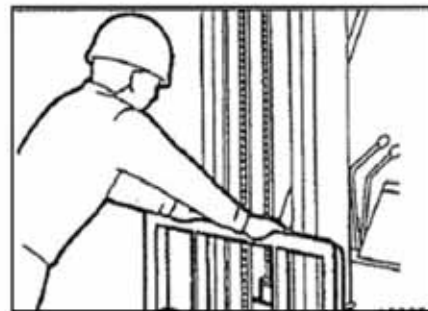
El respaldo (deformación, grietas...)
