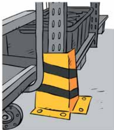
Protección de puntales con colores de seguridad
