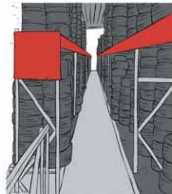
Altura máxima en almacenamiento en estanterías 4,4 m
