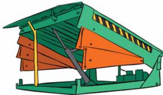
Barra de protección que debe formar parte de la rampa nivelable contra la bajada accidental en las operaciones de mantenimiento
